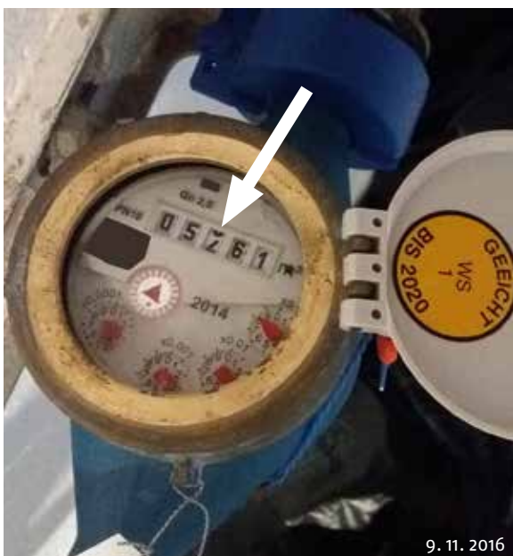
Georg Hofmann hat erstmals einen Rollensprung bei einem Wasserzähler im Bild dokumentieren können. Der Sprung erfolgte um 100 m 3 (von 5360 auf 5461 m 3 ).
